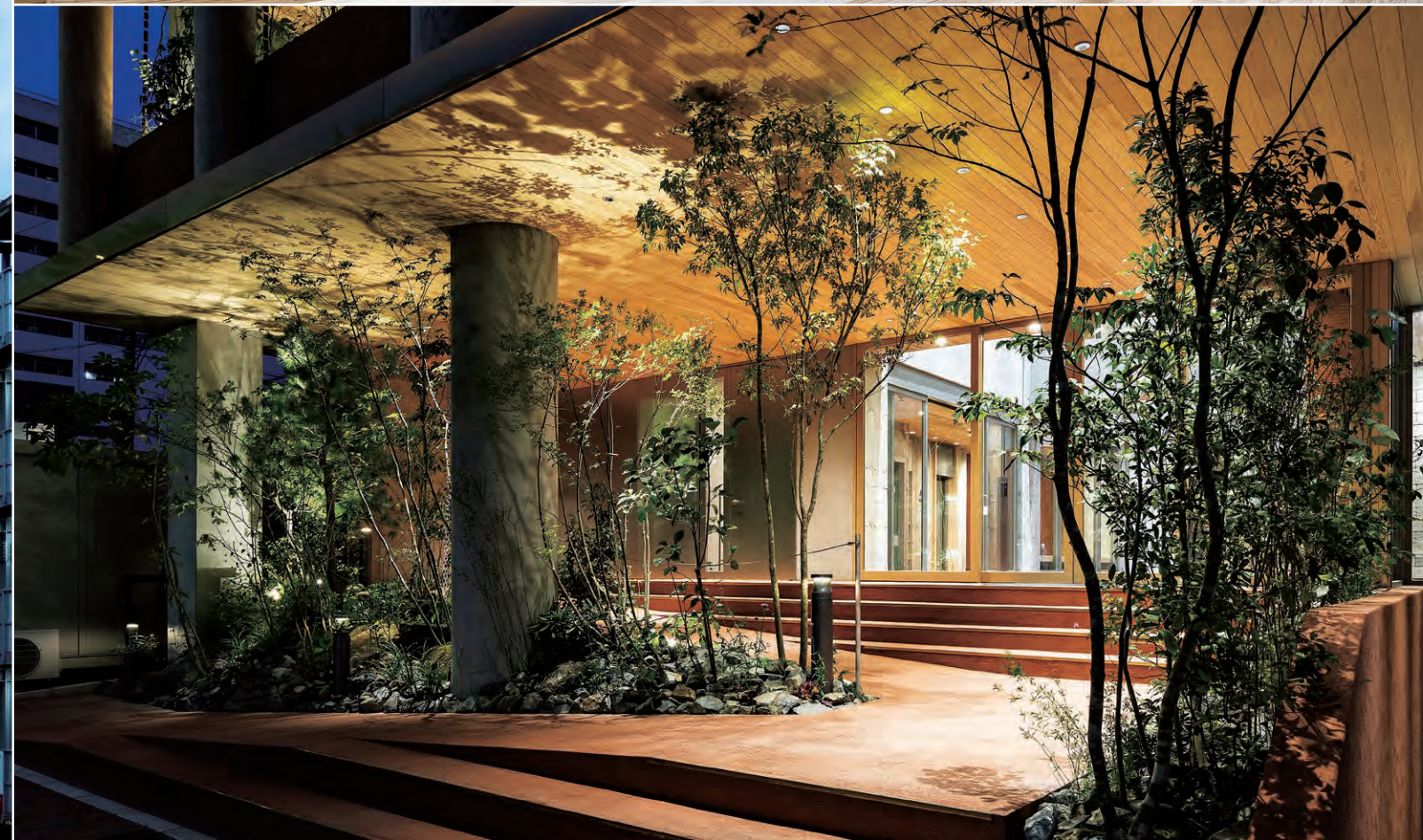
(左) 執務室などから漏れる光でバルコニーを照らすとともに、各フロアバルコニー両端にアップライトを設置して1本の吉野杉が貫通する情景を創り出している (右上) 日没後は照度確保が難しいため、8階ホールではトップライト梁部にスポットライトを設置 (右下) 風除室につながる底にΦ75のグレアレスダウンライトを均等に配置し、スロープにはアクセントとしてガーデンライトを設置している
