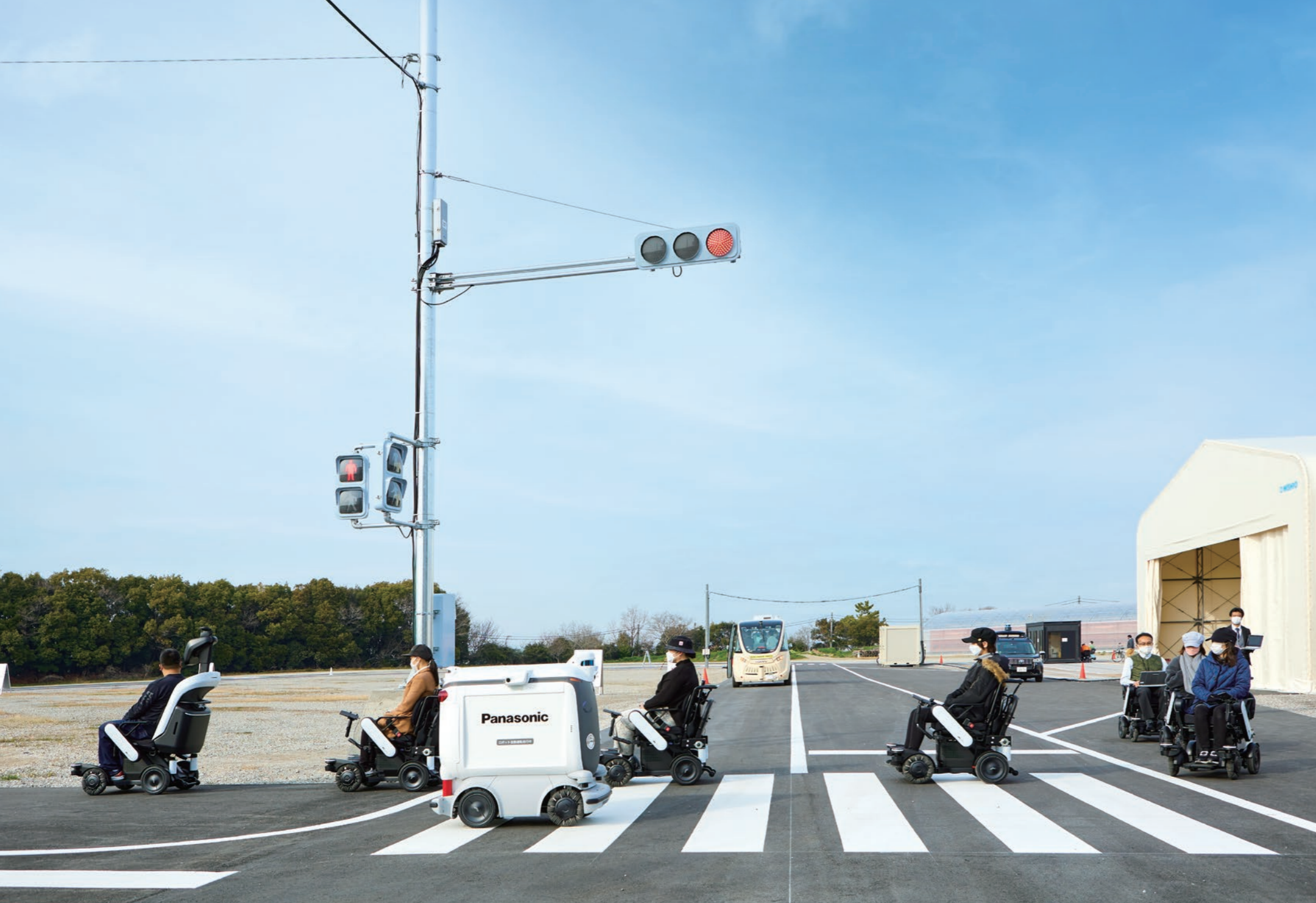
実証実験場に造られた道路で横断歩道を渡る、ロボティックモビリティ「PiiMo」と自動搬送ロボット
