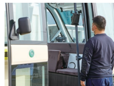
自動運転バスへの乗車を ハンズフリーで行う顔認証システム
