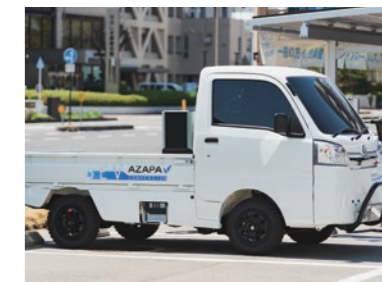
ポータブル蓄電ユニットを利用する コンバージョンEV(P16参照) ©AZAPA株式会社
