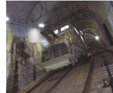
昭和34年に建設されたインクラインで発電所建設に必要な資機材を運搬した。勾配は34度ある。
