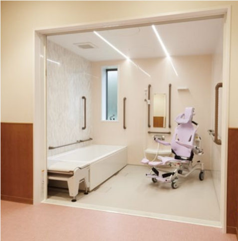
「アクアハート a-Uシリーズ」の浴槽は、またぎやすい高さ・フチのつかみやすさに配慮。Wスピード排水で介助効率も向上
