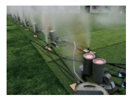
シルキーファインミストとDMXスポットライトをDMX信号で一括制御
