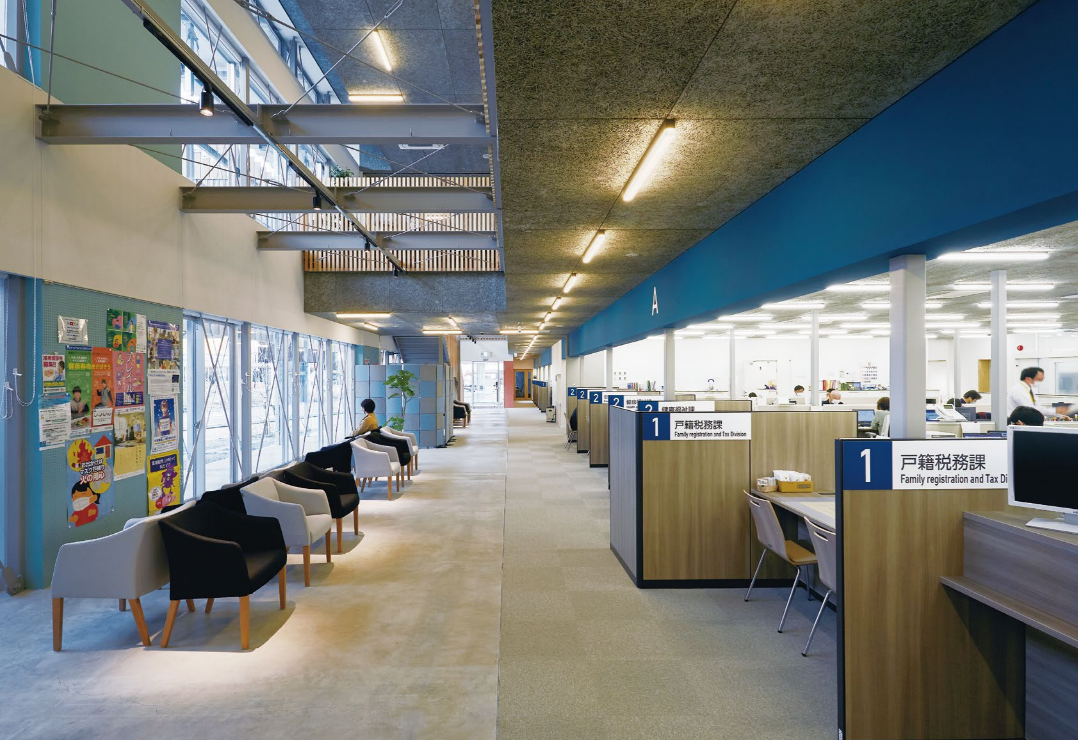
外のエンガワひろばと行き来できる1階エンガワモール。共用部は暖かい光色の照明を用いるとともに、執務室は作業環境に配慮して色温度が高い照明を設置
