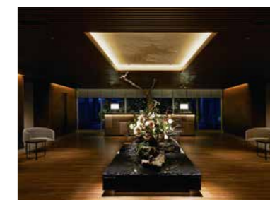
中央のレセプション前に配置されたアートフラワーを照らす間接照明とグレアレスダウンライト
