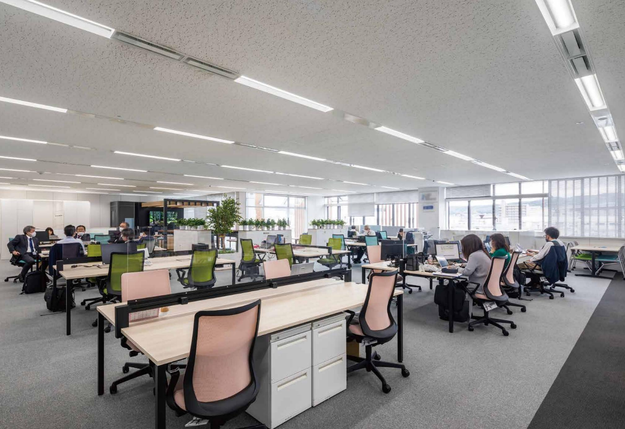
机上面平均照度を500lxに抑えた4階執務室。空間の明るさ感指標「Feu」を活用し、照明器具置き換えによる過剰照度の抑制とダウンサイジングを実施することで、消費電力を大幅削減。左奥に見えるやぐら型のエリアは、清潔・快適な空気環境を提供する「エアリーソリューション」
