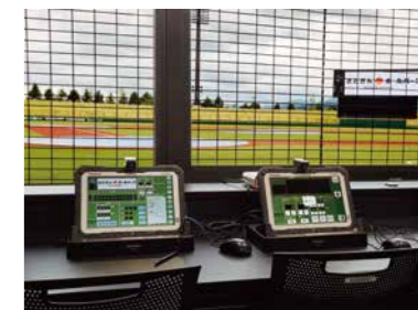
映像を見ながらコンテンツが操作できる制御用タブレット
