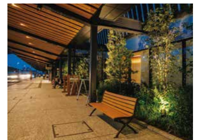
軒下に防湿防雨シーリングライトを設け植栽もライトアップ
