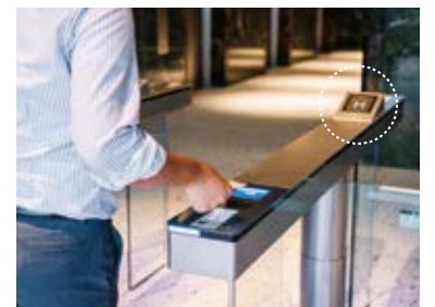
ゲートにシートをかざすと、利用階に合ったエレベーターが呼び出され、番号が表示される
