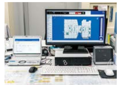
エレベーターと連動し、待ち時間を短縮する統合型セキュリティシステム
