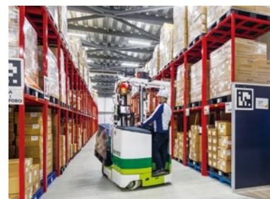
フォークリフトにも位置測定技術「V-SLAM」が搭載され、全作業を記録している
