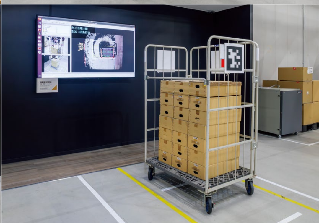
(上左)大阪府茨木市彩都のMFLP茨木6階にある彩都サービスパーツセンターのトラックヤード。(上右)ロボットが運んできた部品を検品する作業もカメラで全て記録している (下左)二次元コードを台車前方のセンサで読み取る、屋内での位置測定技術「V-SLAM」(下右)カート内の充填率をセンサとAIで計測する「積載量可視化」
