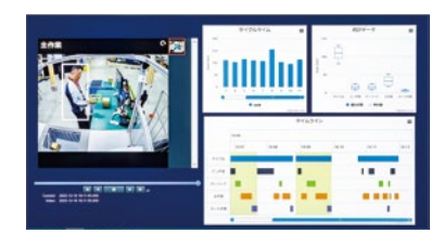
検品作業を「AI画像処理」で作業内容ごとに分類し、映像と合わせて時間軸で記録
