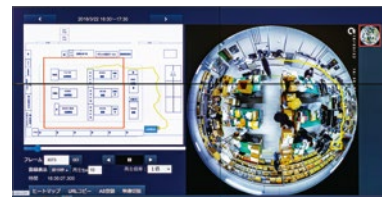
天井のカメラにより作業場の画像を解析し、各作業者の行動を記録
