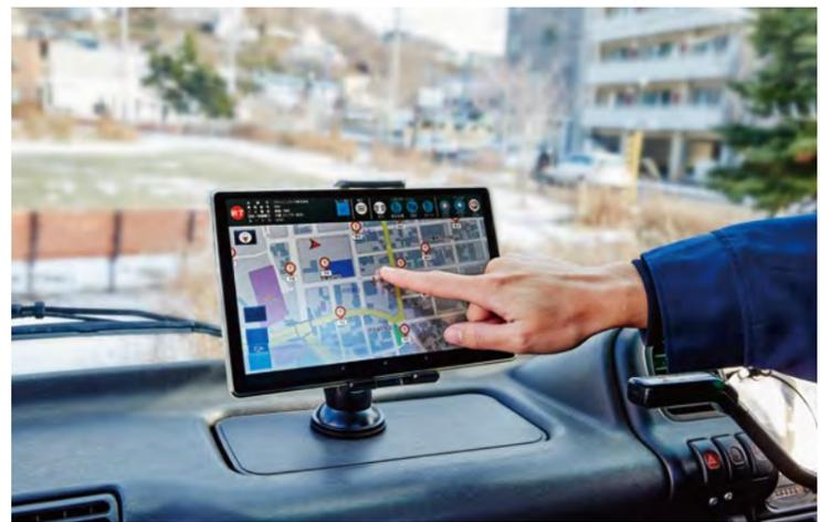
16台の収集車に取り付けられたタブレット。作業中にタップするだけでゴミステーションの収集完了を記録。データは管制センターに送信され、双方で連携を取った収集作業が可能となった
