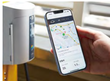
EV充電用コンセントの二次元コードを読み込むと基礎充電が始まり、充電場所がアプリに表示される
