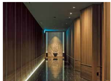
ウォールウォッシュと建築化照明が「中国飯店」からレセプションルームへと誘う
