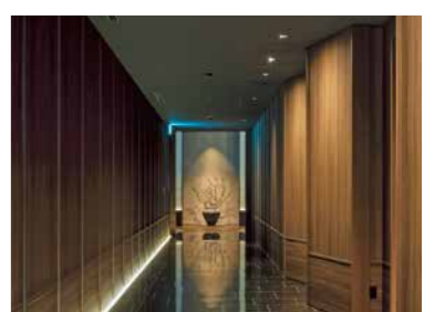
ウォールウォッシュと建築化照明が「中国飯店」からレセプションルームへと誘う
