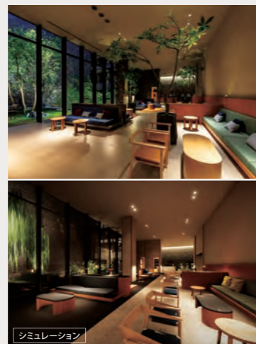
LEDグレアレスダウンライトで壁の鉛直面照度を抑えた手法(上)をライトニングフローで検証(下)
