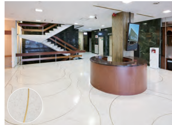
1階ラウンジ。テラゾ仕上げの床に真鍮の目地で波のような曲線が幾重にも描かれている。黒色大理石の壁とのコントラストが際立つ。
