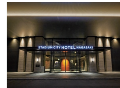
ゲストを招く1階ホテルエントランスのLEDダウンライトと建築化照明
