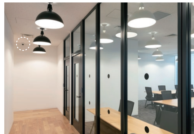
ガラスパーティションで仕切られた各プライベートオフィス。廊下には多くのネットワークカメラが設置されているが、室内映像は撮れないようにマスキングされている
