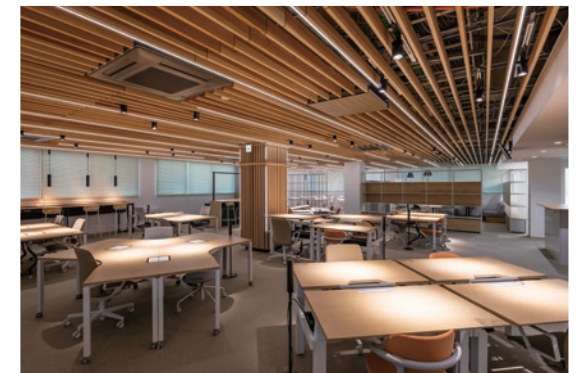
県産材の木製ルーバーに設置したベース照明とスポットライトの組み合わせでリラックス感と集中を両立【奈良県庁 本庁舎】
