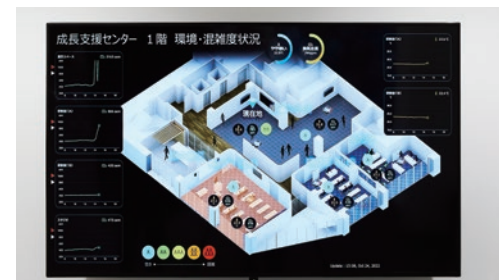
各階の温湿度やCO 2 濃度など、空気環境が一目で確認できるサイネージ【TO-REI 成長支援センター】
