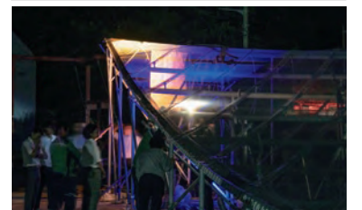
事前にモックアップを作成し、膜屋根を通した昼と夜の反転効果の確認を行った
