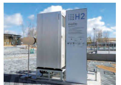
5kWの純水素型燃料電池。NTTパビリオンから地中パイプラインで供給される水素で発電する。
