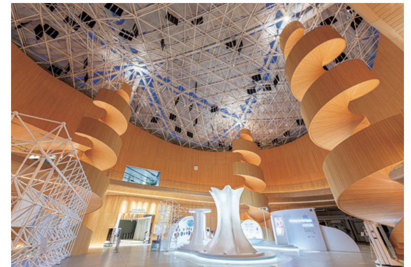
大阪府内産材で構成されたアトリウムには、DNAを模した螺旋状の柱が3本設けられている。螺旋状の柱と屋根を照射することにより、昼と夜で天井の明暗が反転する演出をしている
