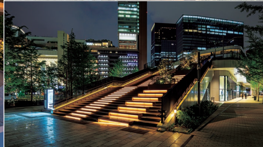
(上) グランフロント大阪側から、うめきたグリーンプレイスの大阪新駅を望む (中) うめきたグリーンプレイスの膜屋根をライトアップし、商業施設としての「にぎわい」を演出 (下) 階段照明は間接照明によりグレアを抑え、足元を照らし出し、安全に2階デッキへと誘導する
