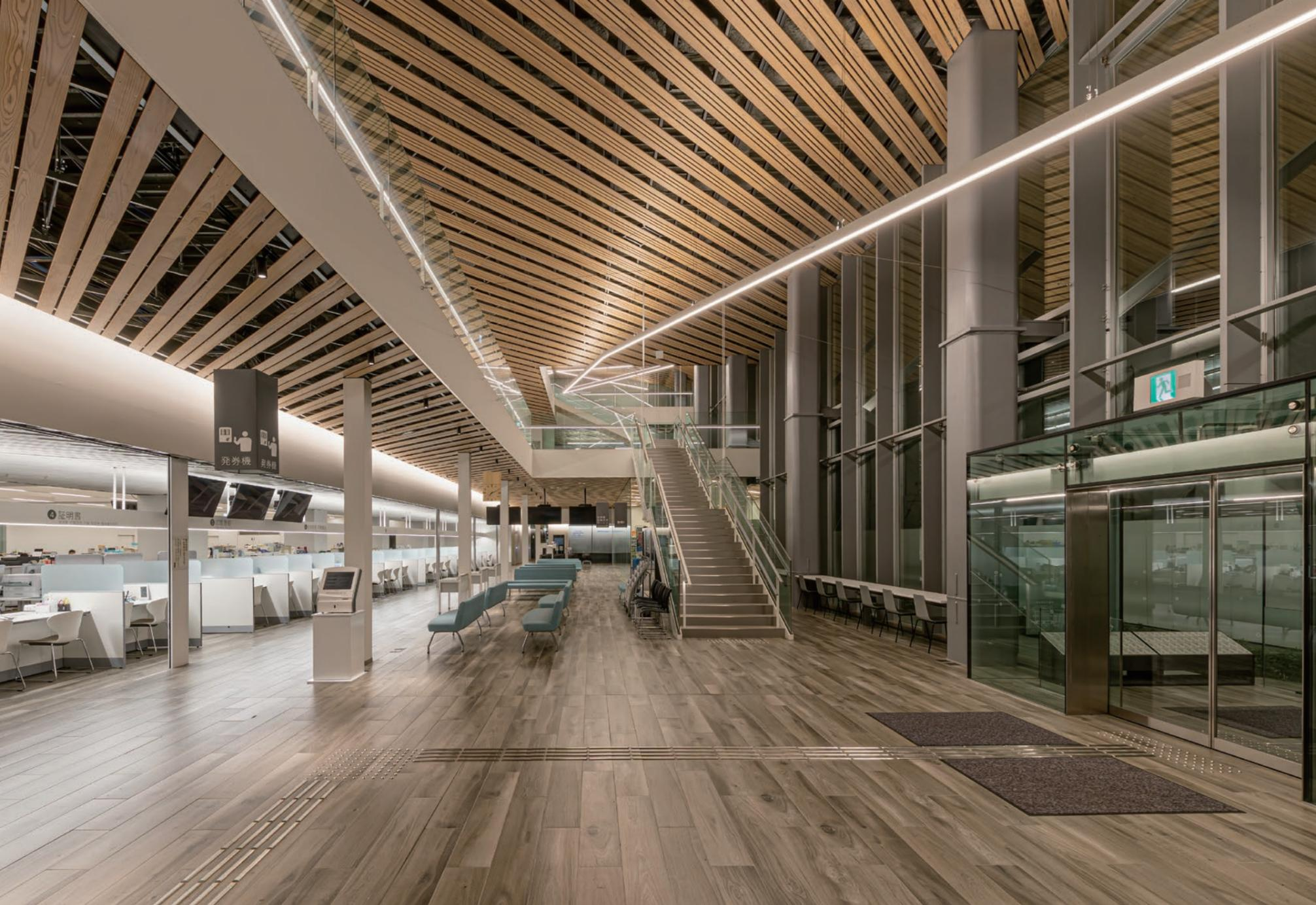
3層吹き抜けのエントランスホールの空間を走るライン照明は、上方光で天井面を照らすとともに、床面に地明かりを確保している。このため高天井用照明器具は設置されていない
