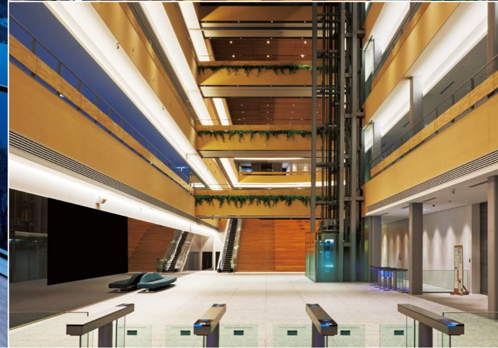
(上) Bldg.A アトリウムは照明のノイズを軽減した特注シーリングとR形状に配置した間接照明で空間を包み込む (下) 間接照明が2階のアトリウムにいざなうBldg.A 5層吹き抜けのエントランス
