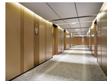
間接光とダウンライトで構成されたBUSINESS TOWERのエレベーターホールの照明
