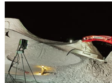
走行面の凹凸を浮き上がらせる 小型フルカラー投光器「ダイナワン」(写真左)
