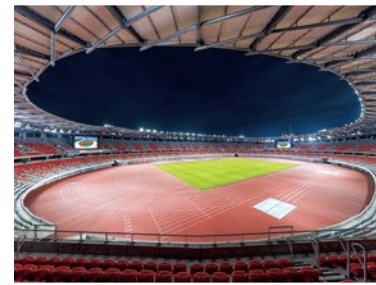
サッカー：FIFAの点灯パターン （計算面高さ1mでの水平面平均2500lx以上）
