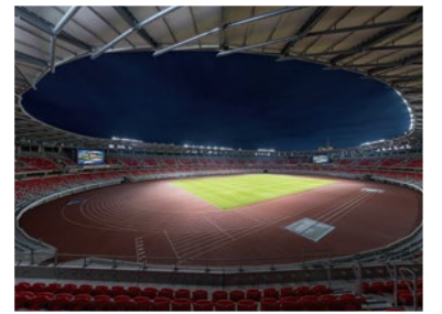
ラグビー：リーグワンの点灯パターン （計算面高さ1.5mでの水平面最小1500lx以上）
