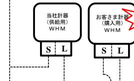
各計器の接続が誤っている場合、使用電力量および発電電力量を正確に計量できないため、接続時には適正な接続となっているか必ず確認してください。
