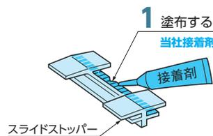
2 F型集水器を取り付ける側の両方の軒とい端面にスライドストッパーを取り付ける。
