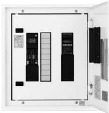
分電盤と同じように低圧配電盤、幹線分岐盤、または引込開閉器盤の幹線より電力供給を受けて、各回路の動力負荷までの電路保護のための分岐遮断器と負荷の自動運転及び保護のための電磁開閉器 (Mctt)、サーマルリレー (Th-Ry)、その他操作機器表示機器、制御機器などを負荷運転目的別に有機的に集合させたもの。
