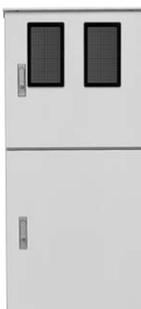
低圧電力契約の場合、電力会社との取引用電力量計(WHM)と引込開閉器としての遮断器を取り付けたもの。なお使用上や施工の関係でWHM部を分離する場合もある。使用目的から、屋外の雨線内の壁面施工が一般的である。鋼板製とステンレス製がある。
