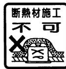
器具は、断熱材・防音材・造営材等と下図のような空間を設けて施工してください。
