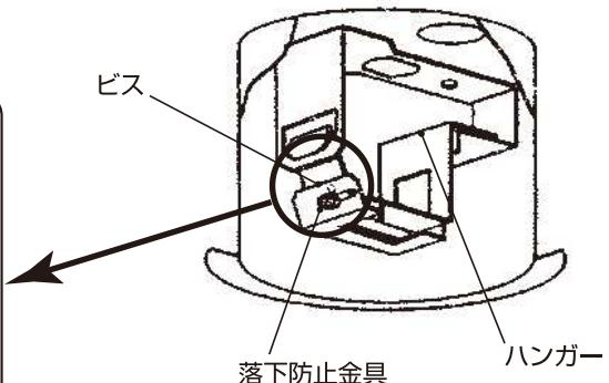
③ハンガーのパイプ引掛け穴に電源線・アース線を通した後、
