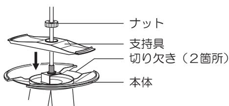
② 本体の切り欠き（2箇所）にカバー開口部を沿わせながらカバーを取り付ける。
