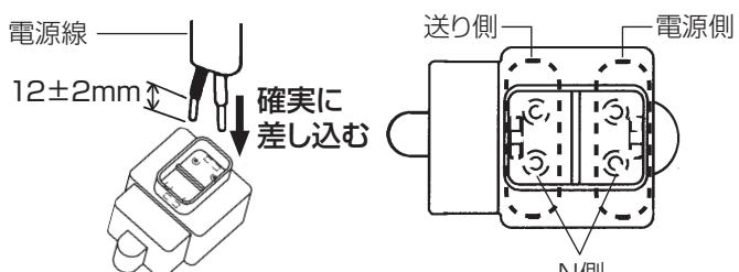
器具の取り替えなどで電源線を外す場合は、マイナスドライバーなどで解除ボタンを押しながら電源線を引き抜く。
