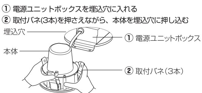
●石こうボードに取り付けた器具を取り外す場合は、枠部をゆっくり引き下げて取付バネ(3本)を押し曲げながら取り外してください。
