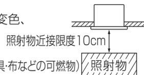
●本体を埋込穴に確実に押し込む
