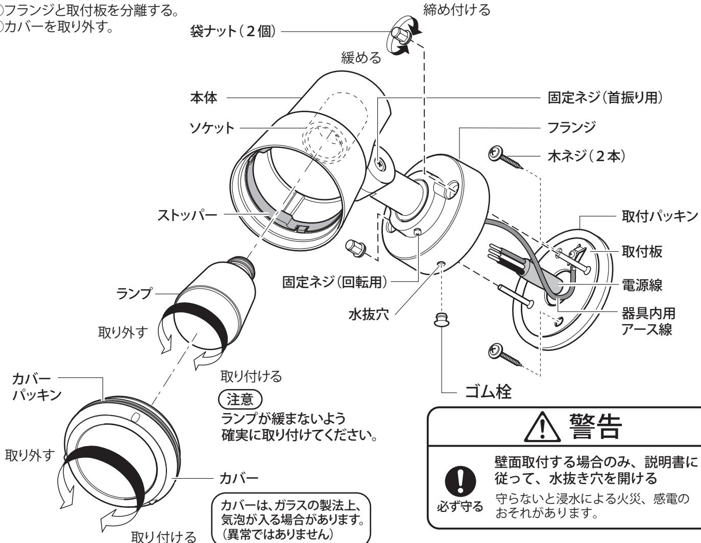
壁面取付する場合のみ、説明書に従って、水抜き穴を開ける
