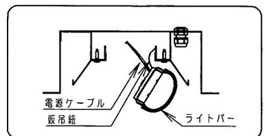
注) 電源線接続後、余分な電源線はライトバーとの当たりを防ぐため本体側へ押しつけて処理すること。ライトバーが垂れ下がり、反射板とライトバーの隙間の原因となります。
