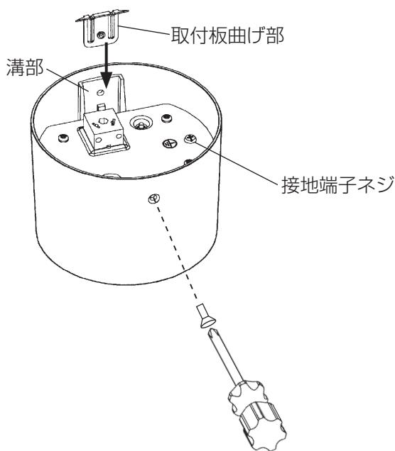
②接地端子ネジよりD種(第3種)接地工事を行う。
