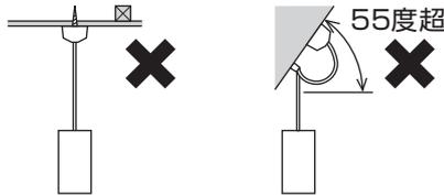
●コードハンガーを使用しない場合傾斜天井不可。傾斜天井にコードハンガーを取り付ける場合はフック開口部が上を向くように取り付けてください。
