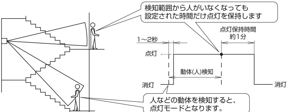
・専用電源投入直後はセンサのウォームアップのため、約20秒間強制的に点灯します。
