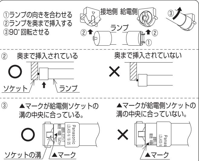
取付けが不完全な場合、ランプ落下、照度低下の原因となります。
