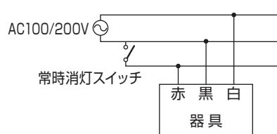
C. 自火報連動による100%点灯なし・信号装置消灯あり(3線式配線)の場合
