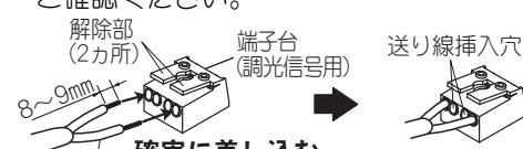
適合電線：CPEV線  $\phi 0.9$ 、 $\phi 1.2 \times 1$ ペア
