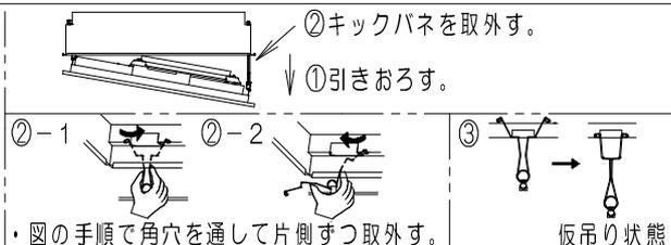
・図の手順で角穴を通して片側ずつ取外す。
