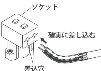
器具の取り替えなどで電源線を外す場合は、解除ボタンを押しながら電源線を引き抜く。
