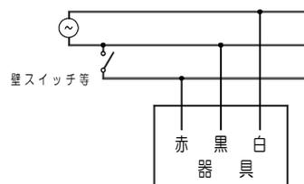
※器具端子台の短絡線を取り外して配線してください。
