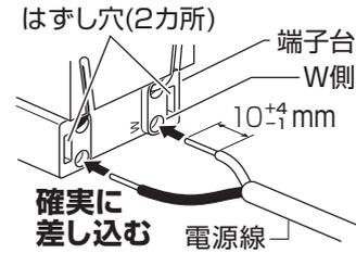
器具の取り替えなどで電源線を外す場合は、マイナスドライバーなどをはずし穴に差し込みながら電源線を引き抜く。器具側の電線が一緒に抜けている場合がありますので、最後に指などで押して確実に接続されているか確認する。
