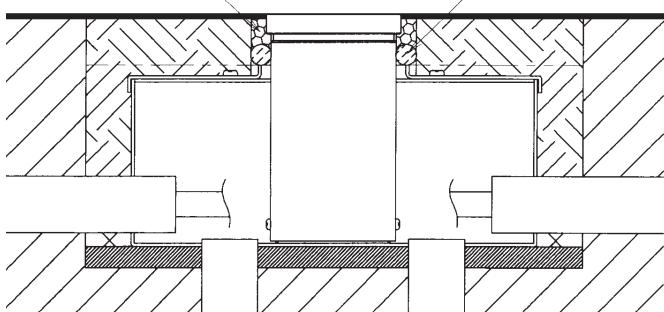
**!** 地表と器具表面が必ず平滑になるよう特に注意して施工処理を施してください。
