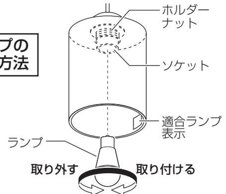
・ホルダーナットが十分に締め付けられていることを確認してください。
