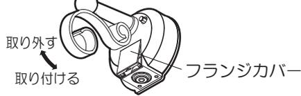
フランジカバーは必ず取り付けて使用してください。フランジカバーを取り外したまま使用すると、水が浸入し、感電・故障の原因となります。
